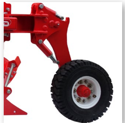
Hinterrad mit einer Breite von 138 mm und einem Durchmesser von 480 mm.
