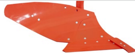
MP4WC - Vollschar, zylindrisch, ideal für sandige/lehmige Böden. (Arbeitstiefe 25-40 cm).
