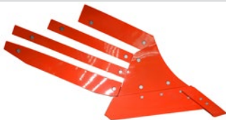
MP4C - Streifenkörper, zylindrisch, ideal für sandige/lehmige Böden. (Arbeitstiefe 25-40 cm).
